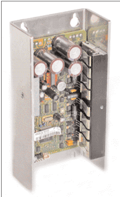
Рис. 2. Драйвер SDMWA130 обеспечивает в автономном режиме контроль перемещения для процессов маркировки, цифровую пошаговую подачу и управление нанесением индексов
